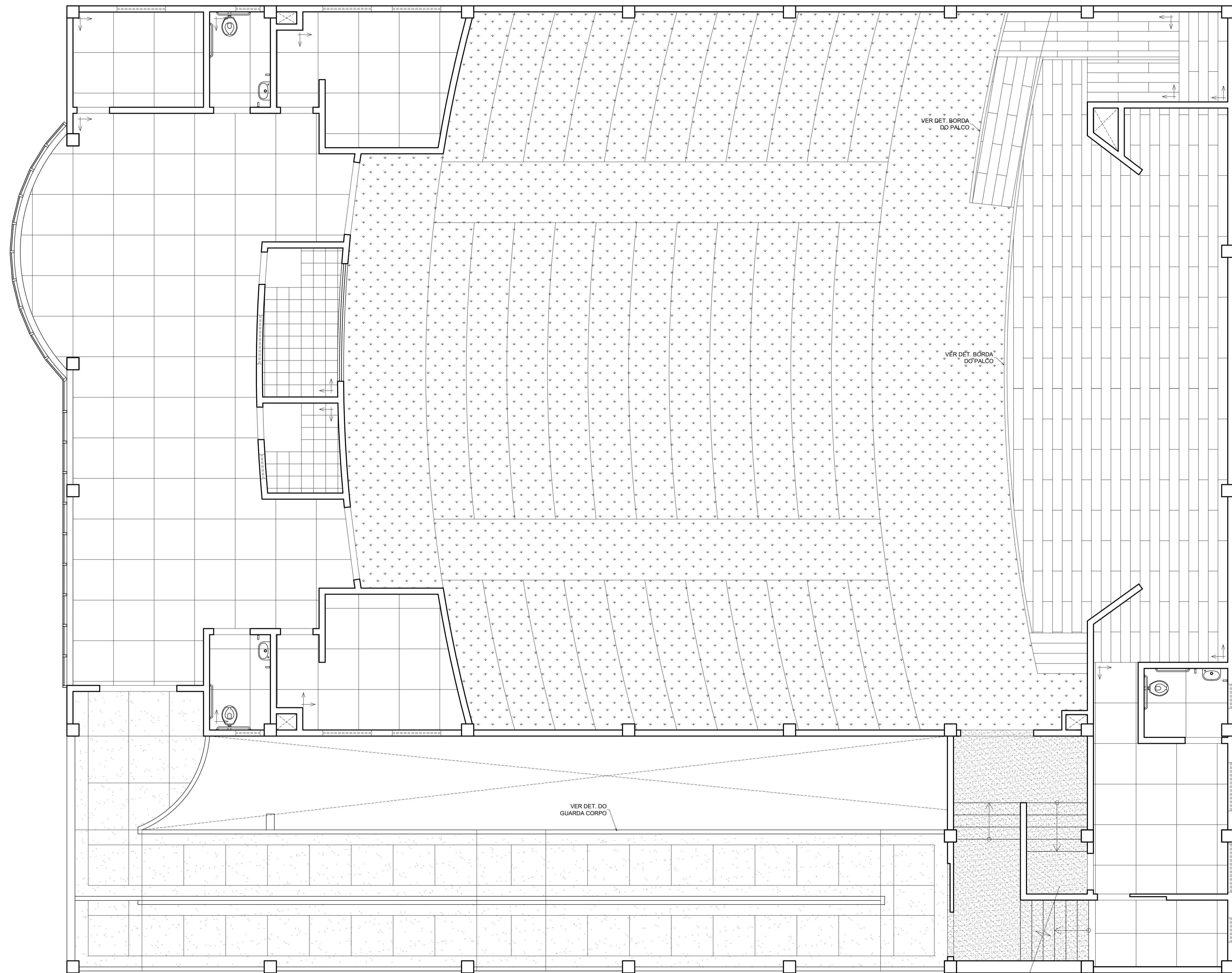
LAYOUT DAS JUNTAS DE PISO - AUDITÓRIO ESC.: 1/50
