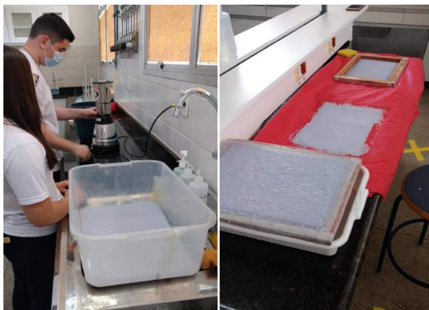
Figura 1 e 2. Equipe de alunos fabricando papel reciclado. 1, à esquerda, destaque para a bacia contendo a massa de papel triturado. Em 2, na direita, formas de madeira com a massa de papel coletada e em processo de secagem.
