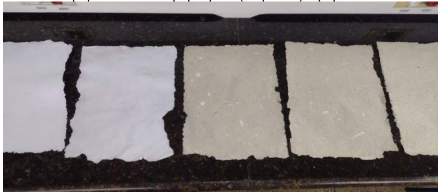
Figura 7. Folhas de papel feitas com papel puro (esquerda) e papel mais fibra de bananeira
