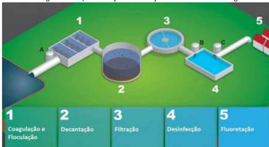
Figura 1: Representação da estação de tratamento de água
