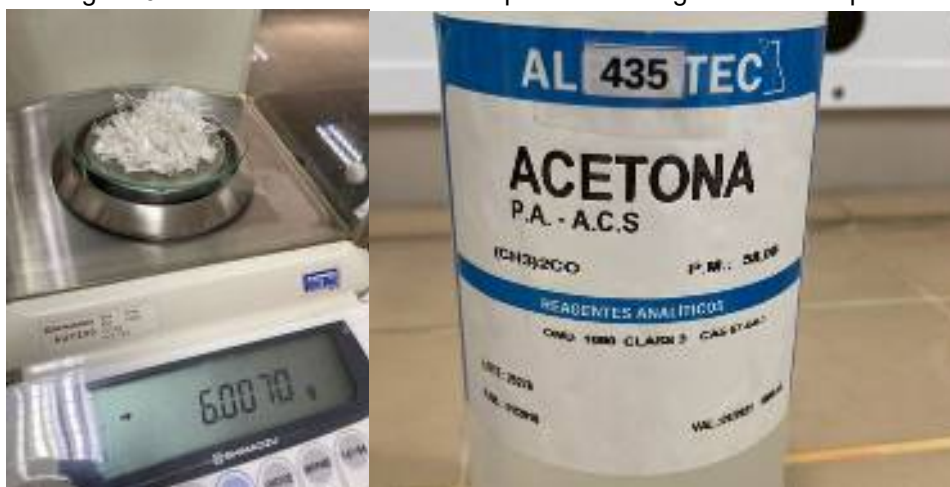
Figura 6 - Filamentos de ABS sendo pesados e reagente acetona pura.
