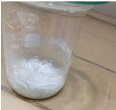
Figura 7 - Filamentos de ABS que não reagiu.
