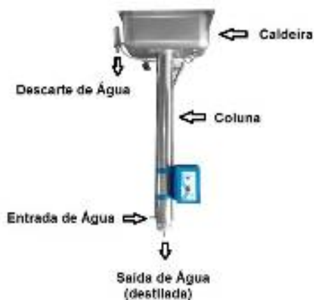
Figura 2. Partes do destilador tipo Pilsen
