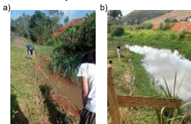
Figura 3 – a) Registro da medição da área para o cálculo da vazão no P1. b) Registro de cronometragem do objeto flutuante no P3.
