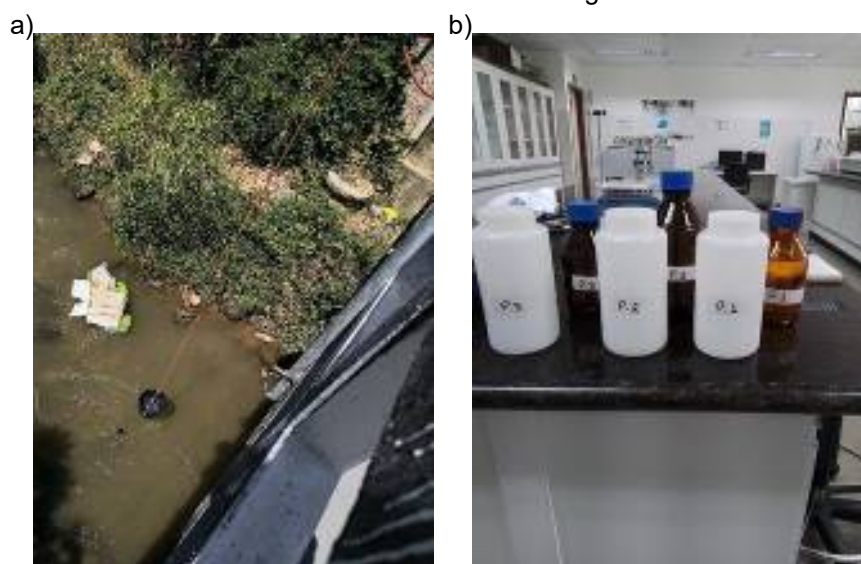
Figura 2 – a) Registro da coleta da amostra com balde no P2 no período seco. b) Frascos utilizados para armazenar as amostras de água.
