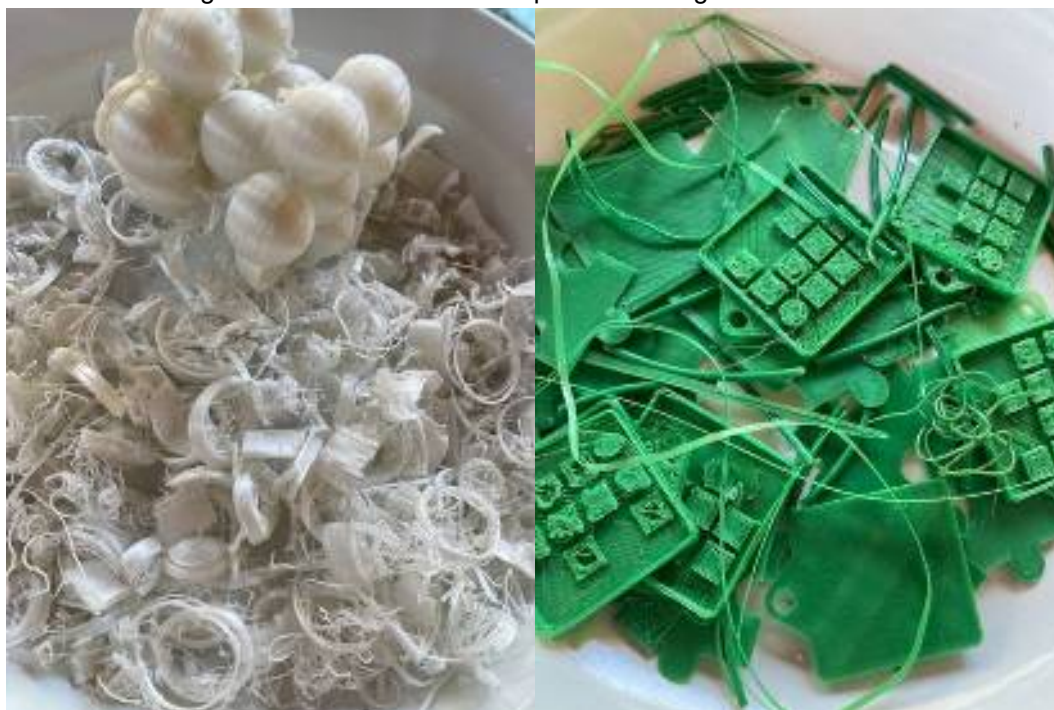
Figura 2 - Materiais utilizados para a reciclagem ABS e PLA.
